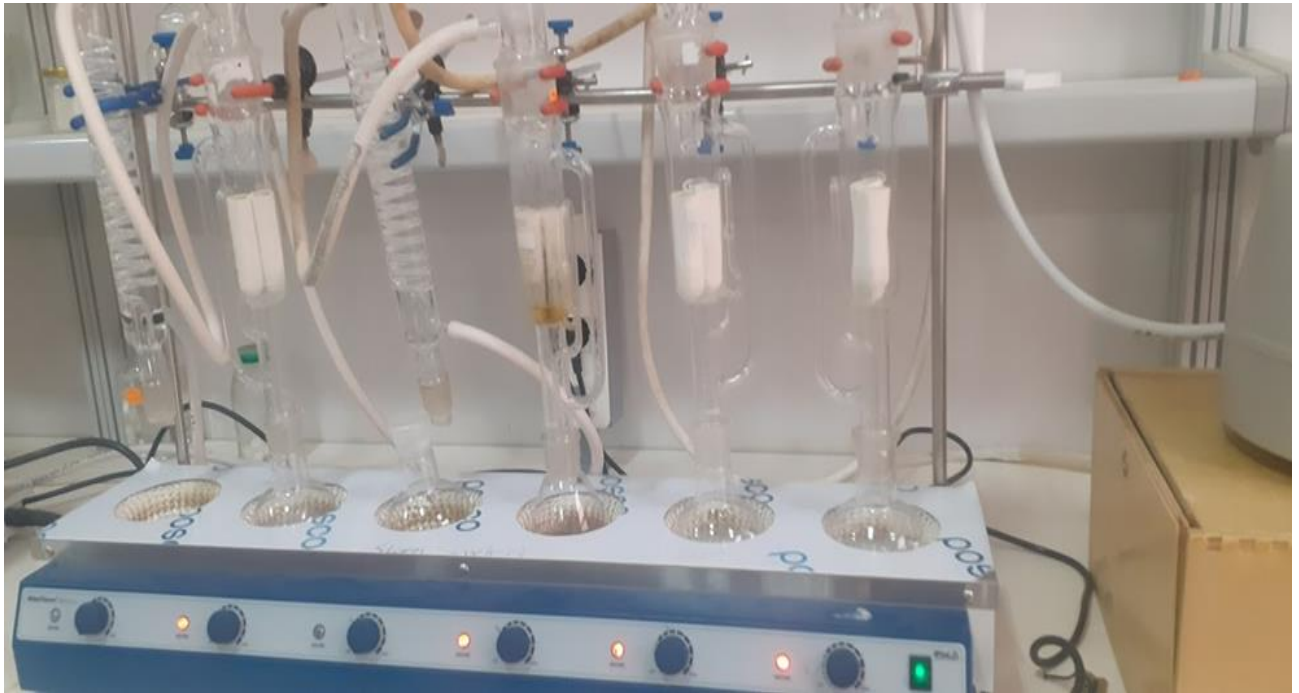
Figure 10 : Montage de soxhlet utilisé pour l'extraction de l'huile Cleome arabica
