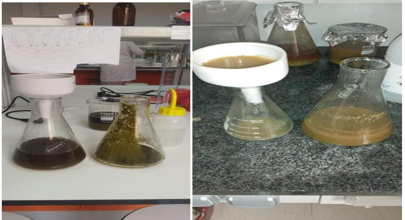
Figure 13: photo illustrant la Filtration de l'huile de Cleome arabica obtenu par macération
