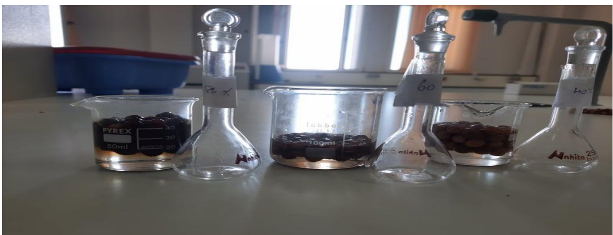
Photo 15 Le trempage des grains dans l'acide sulfurique pour les trois concentrations pendant 20 min (Kacemi H, .Lardja À, .2021)
