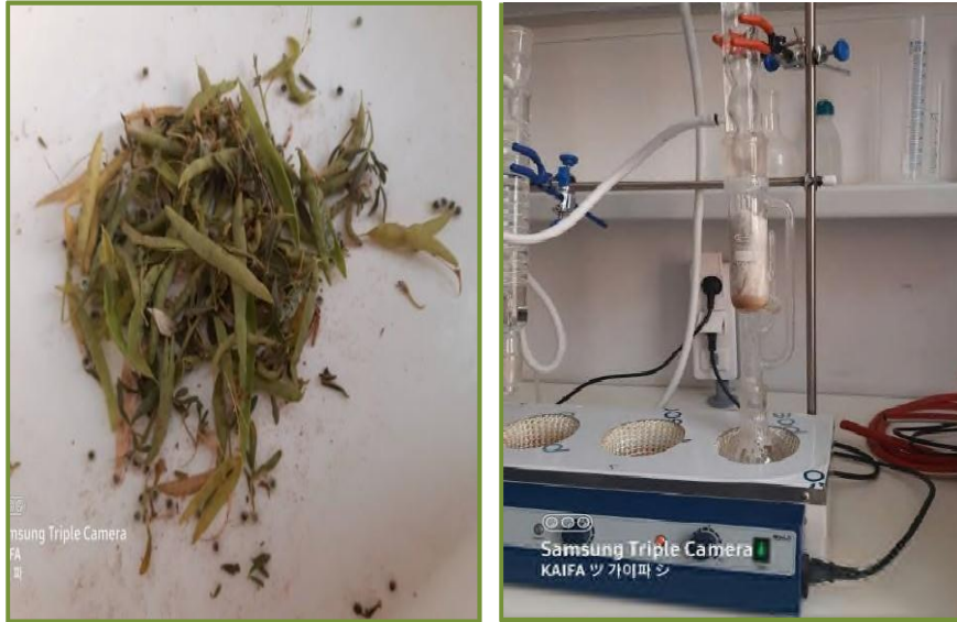
Photo.6. Extraction de Cleome arabica par le soxhlet
