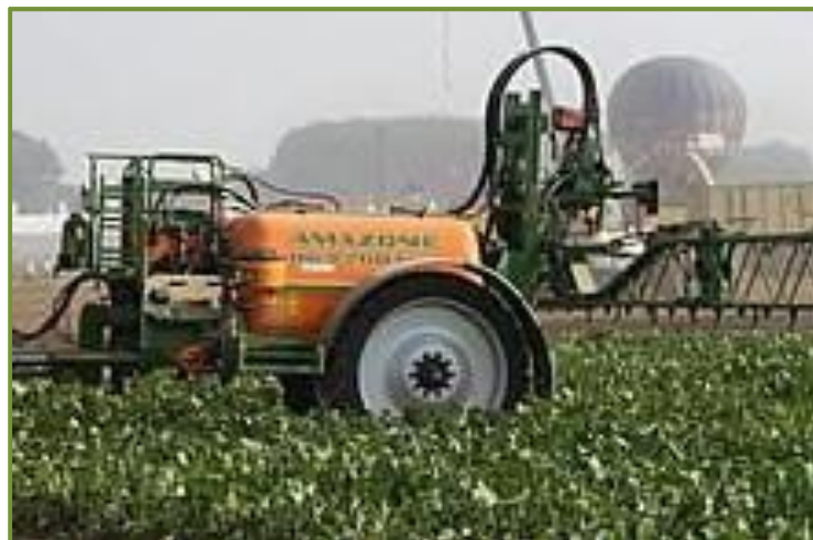
Figure.2. Pulvérisation d'herbicide grâce à un pulvérisateur (werktuigendagen 2009)
