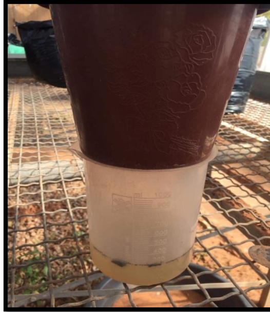
Figure17 -filtration d'eau après 48h(photos prise par Koudache et Limam,2022)
