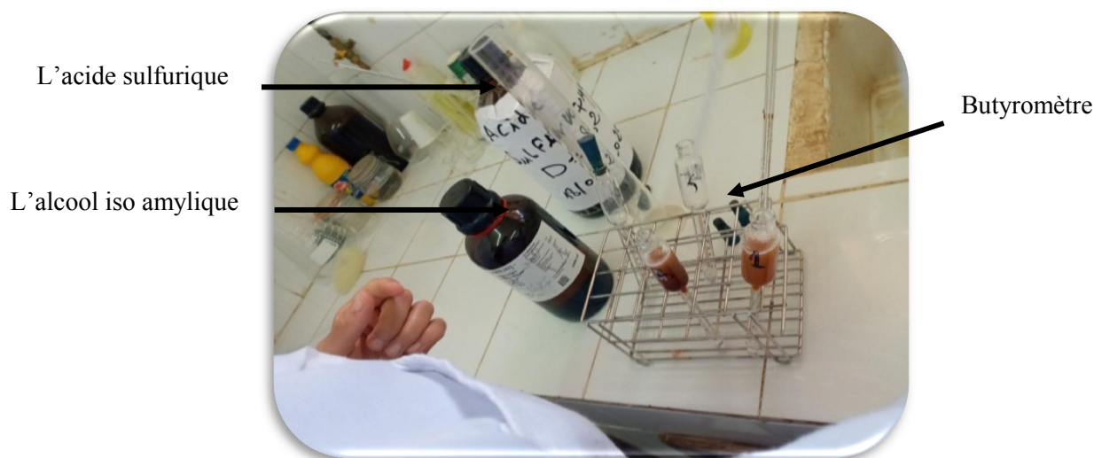
Figure 07: a-Préparation du butyromètre à la prise d'essai
