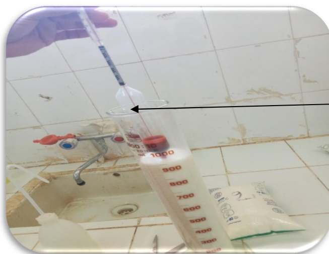
Figure 06: Mesure de la densité par lactodensimètre (source: Arbaoui et Lairedj; Laboratoire du contrôle de qualité (avril 2021))
