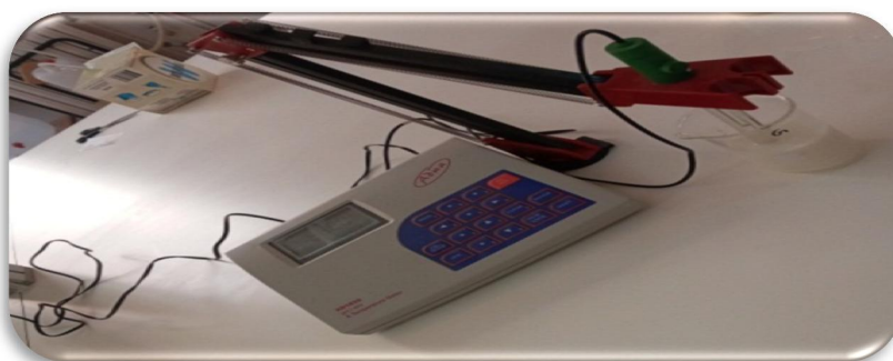
Figure 04: Mesure du ph (Source Arbaoui et Lairedj) Laboratoire de Chimie CUN Avril 2021
