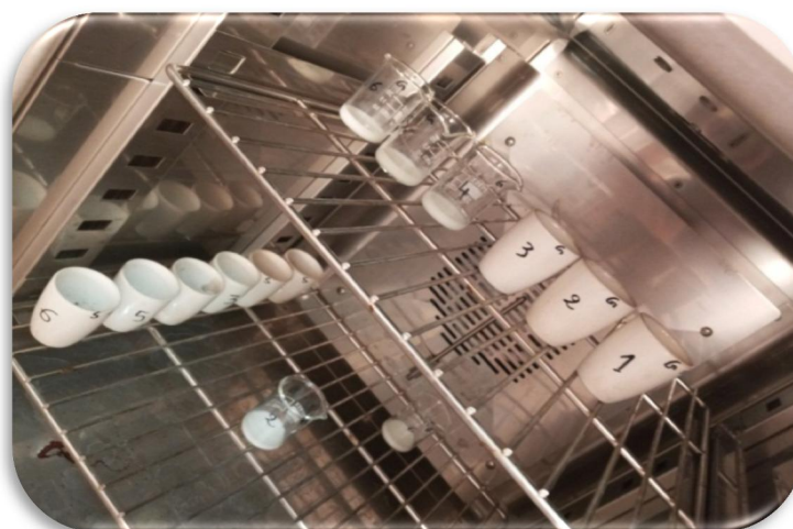
Figure 08: b-étuve pour le séchage de l'échantillon
