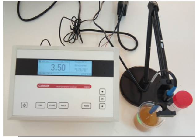
Photo 07. Mesure la conductivité électrique des solutions
