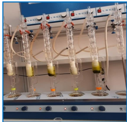
Photo 8 : Extraction de J.phoenicea L. à l'aide d'un appareil « Soxhlet » à 6 postes.
