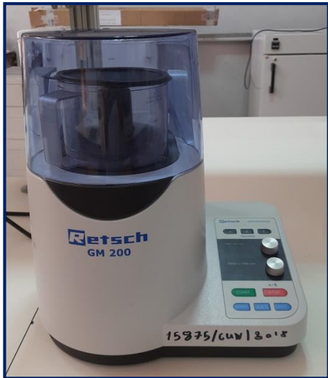
Photo 5 : Broyeur électrique « Retsch GM200 ».
