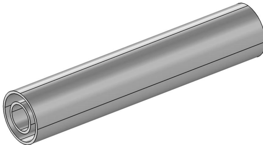
**Figure II.1 : Schématisation de l'échangeur tubulaire concentrique.**
