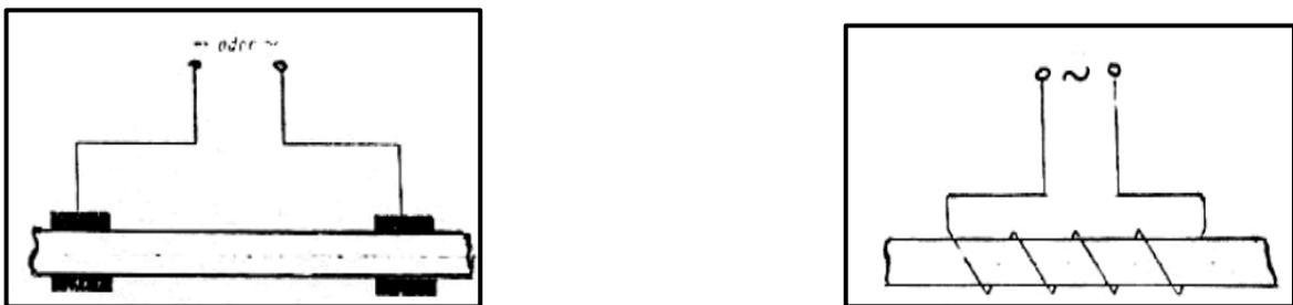
**Fig.II.2.** a) Chauffage par résistance, b) Chauffage par induction [22]
