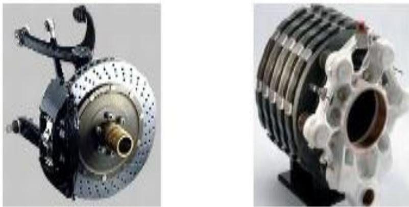
**-a-** : Frein à disque automobile. **-b-** : Frein à disque aéronautique.
