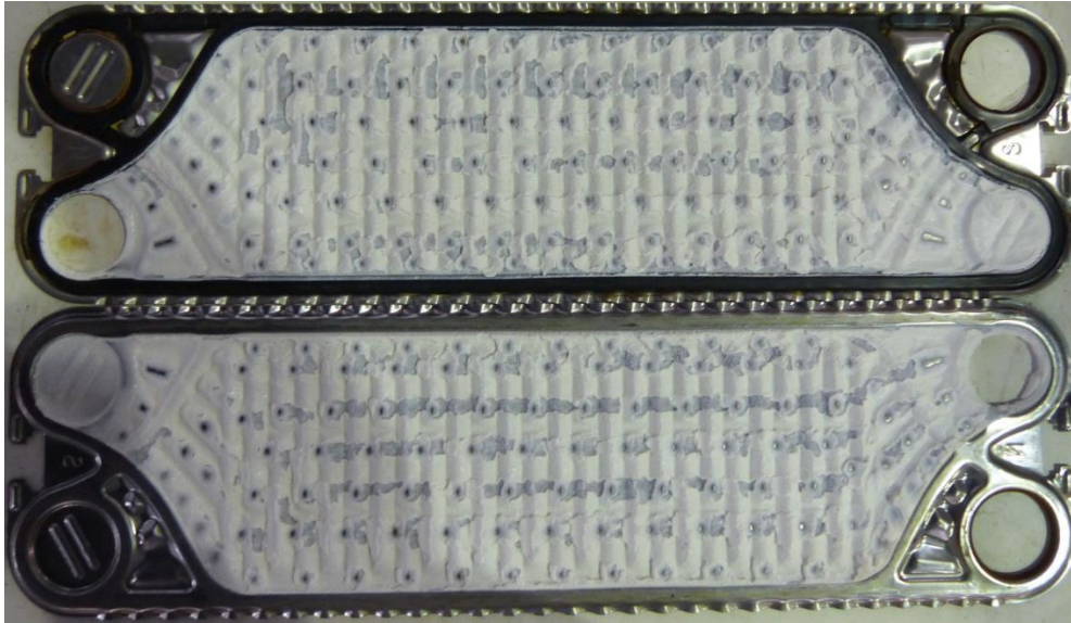
Figure II.5 : Photo de plaques d'un échangeur de chaleur encrassé
