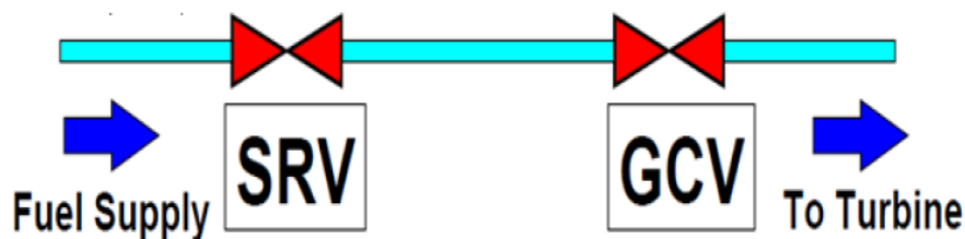
Figure 2.18: Système du gaz combustible.
