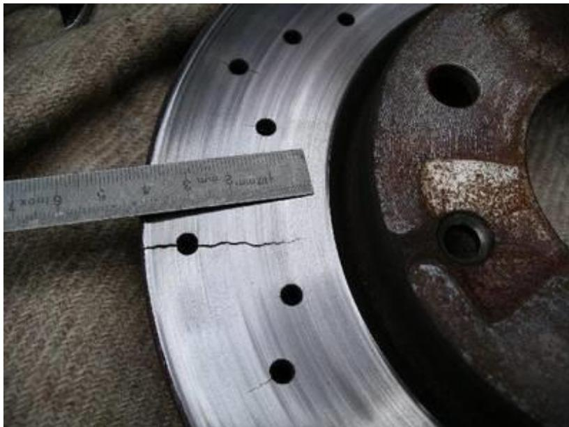
Fig. I.19. Disque fissurés..[10]
