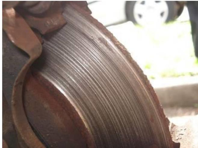
Fig. I.20. Disque endommagé par le fer d'une plaquette [10]
