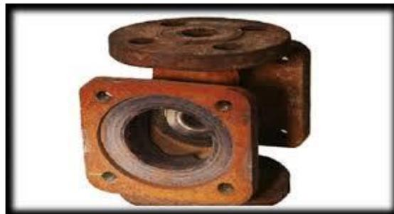
*Figure III.1: Corrosion générale (rouille) d'une pièce en acier [36].*
