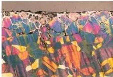
Figure III.3: Fissures de corrosion sous contrainte (CSC) [36].
