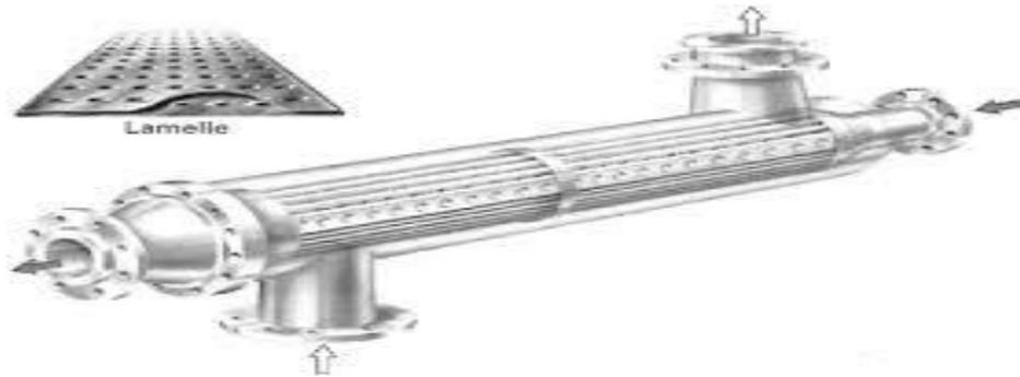
Figure II.24: Échangeur lamellaire [28].
