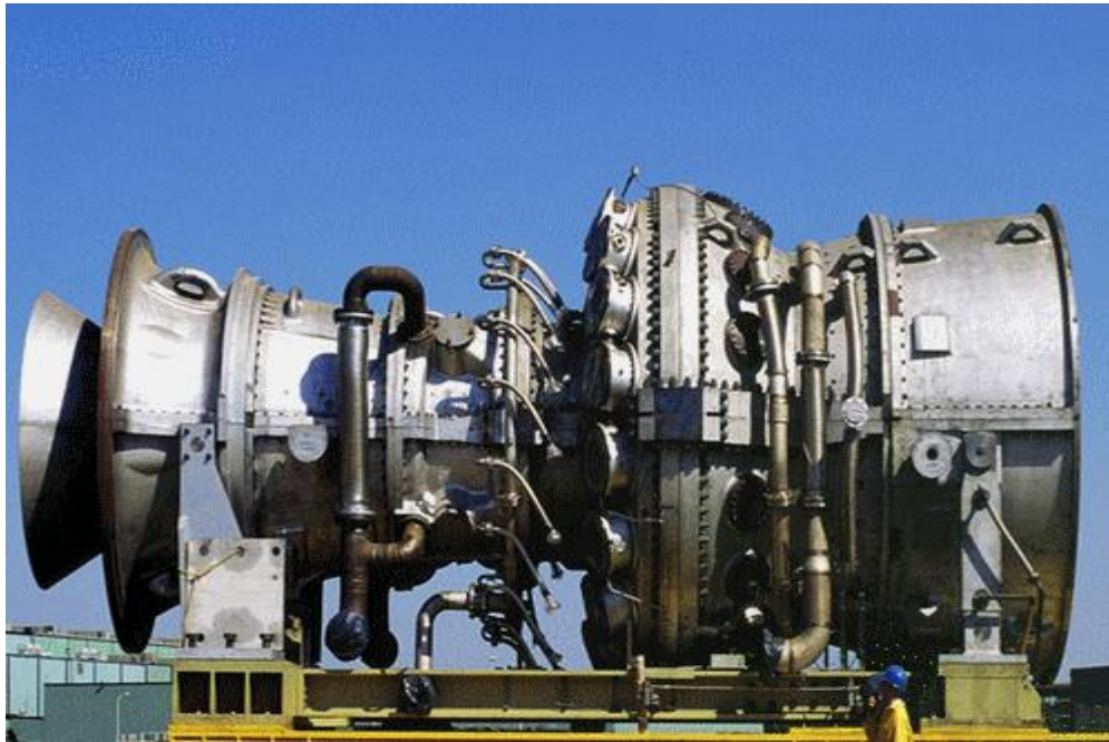
Figure II-2 : la turbine à gaz 9FA.
