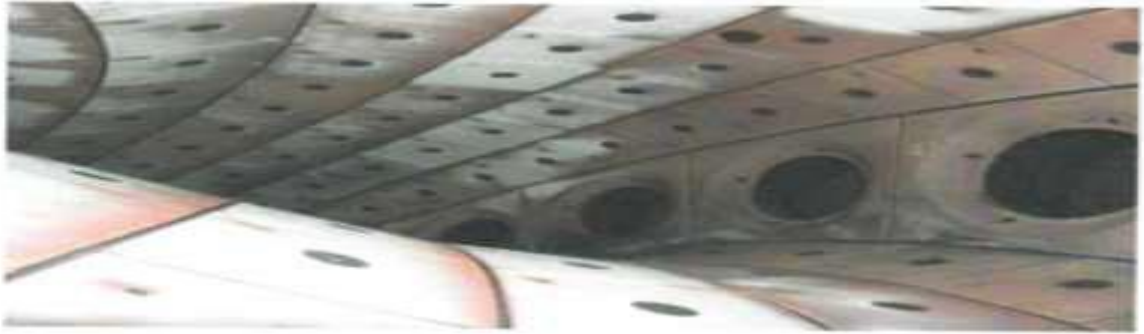
Figure II-4 : Vue interne de la chambre de combustion.
