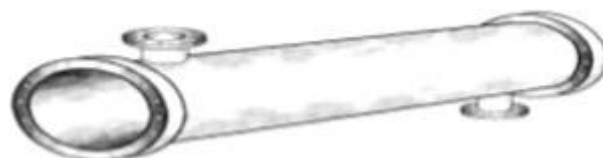
Figure 2.14 : Calandre simple à une seule phase.
