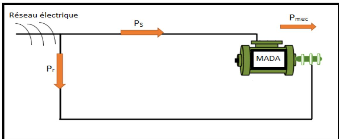
**Figure II.8 :** Fonctionnement moteur hyper-synchrone
