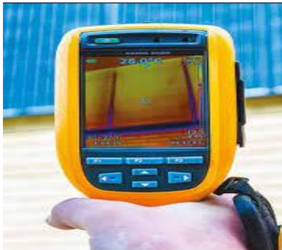
Figure II.12: Méthode de l'imagerie numérique infrarouge thermique
