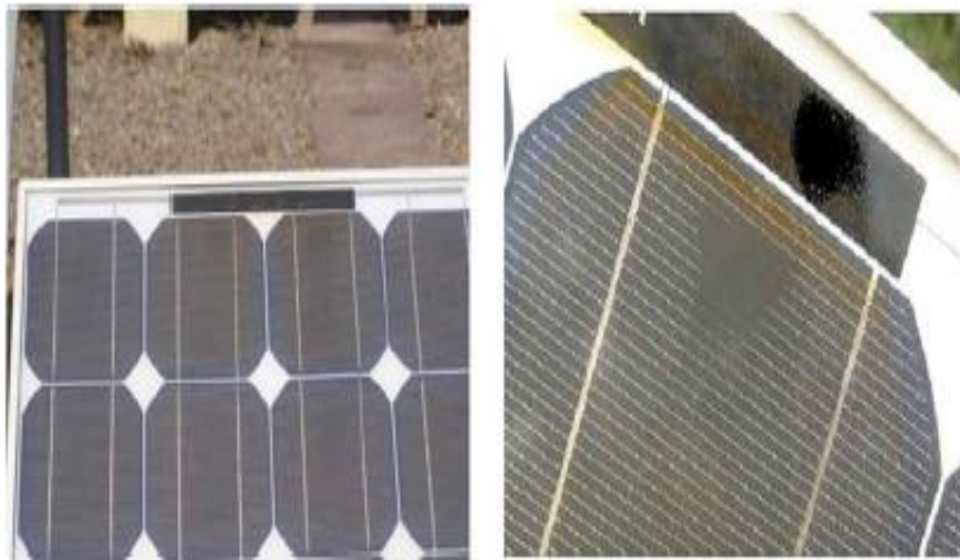
Figure II.11: La détérioration de la peinture antireflet
