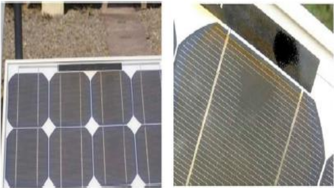
Figure II.1 : Défaut de Jaunissement
