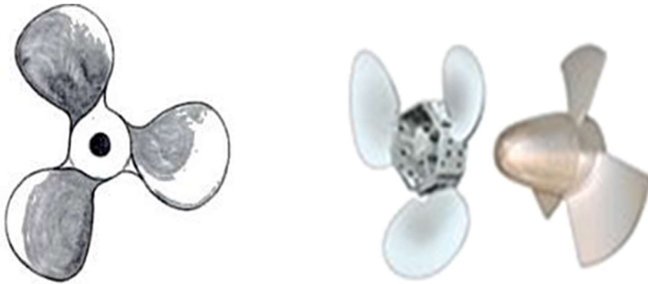
Fig. 2.3 Hélice pour agitateur : type marine
