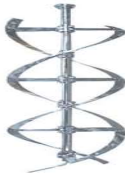
Fig. 2.10. Hélice pour agitateur hélicoïdal
