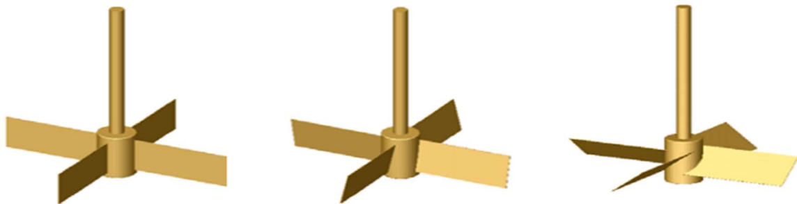
Turbine à pales droites \alpha=90^\circ Turbine à pales inclinées \alpha=60^\circ Turbine à pales inclinées \alpha=45^\circ
