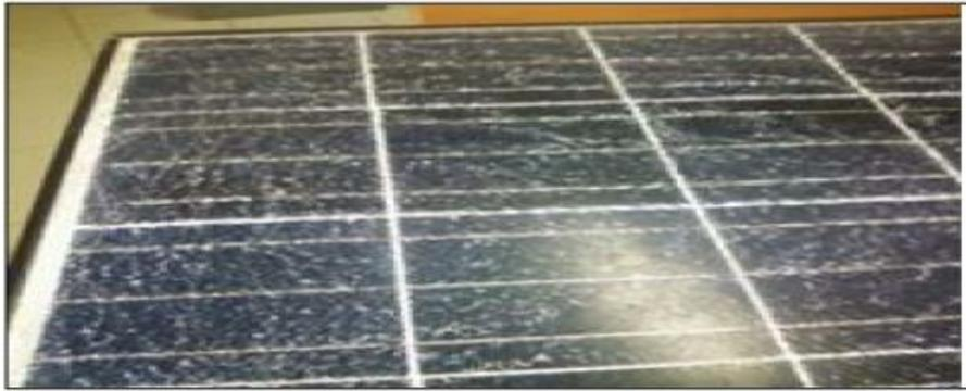
**Figure II.5:** Dégradation de module photovoltaïque par des bris de verre.
