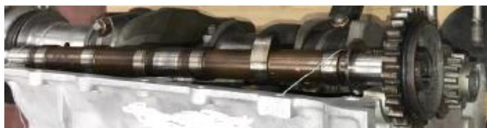
*Figure 12: L'arbre à cames et les engrenages de distribution.*
