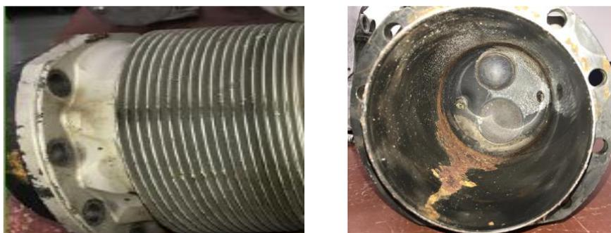
*Figure 6: Vue latérale et au-dessous d'une cylindrée démontable refroidie à air*
