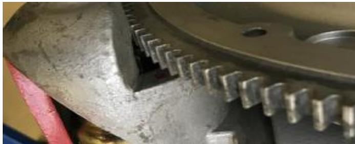
Figure 10: Volant moteur en contact avec le démarreur.
