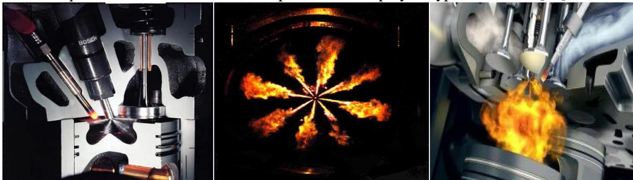
Figure 20 : Combustion Diesel et vues de l'injection directe dans la chambre de combustion.
