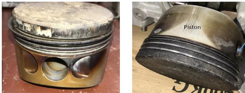
*Figure 7: Piston avec segments*
