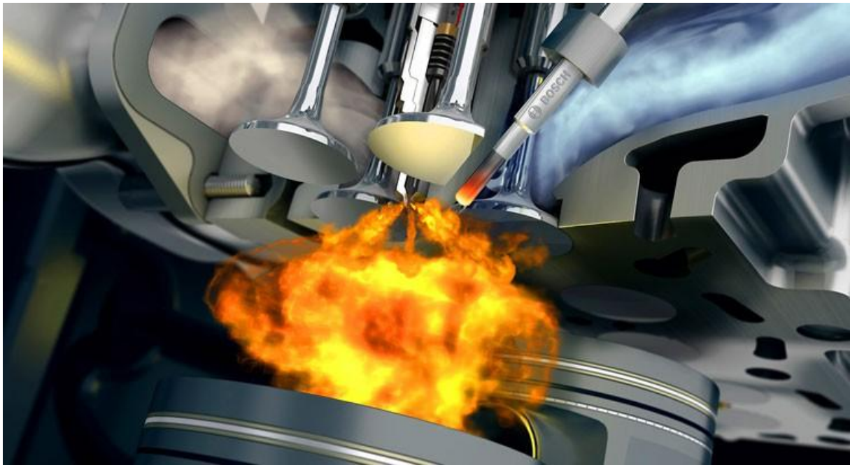
Figure. 5: la chambre de combustion
