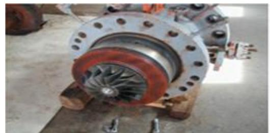
Figure III.9 : Roue de la turbine
