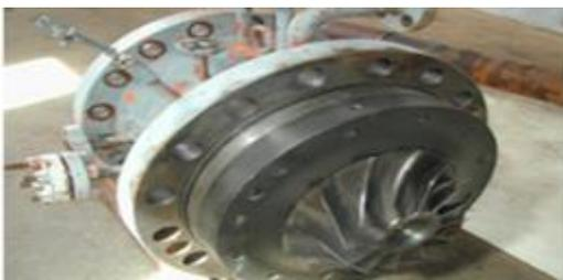
Figure III.8 : Roue du compresseur
