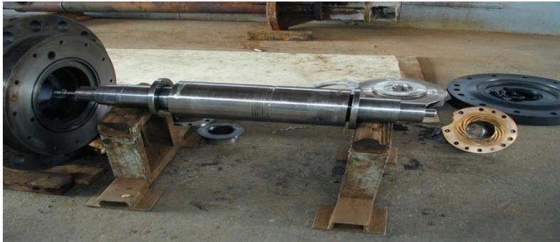
Figure III.10 : l'arbre de l'Expander compresseur
