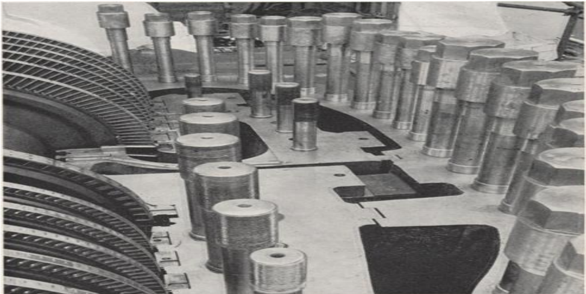
Figure n°I.11 : Les brides d'assemblage des enveloppes
