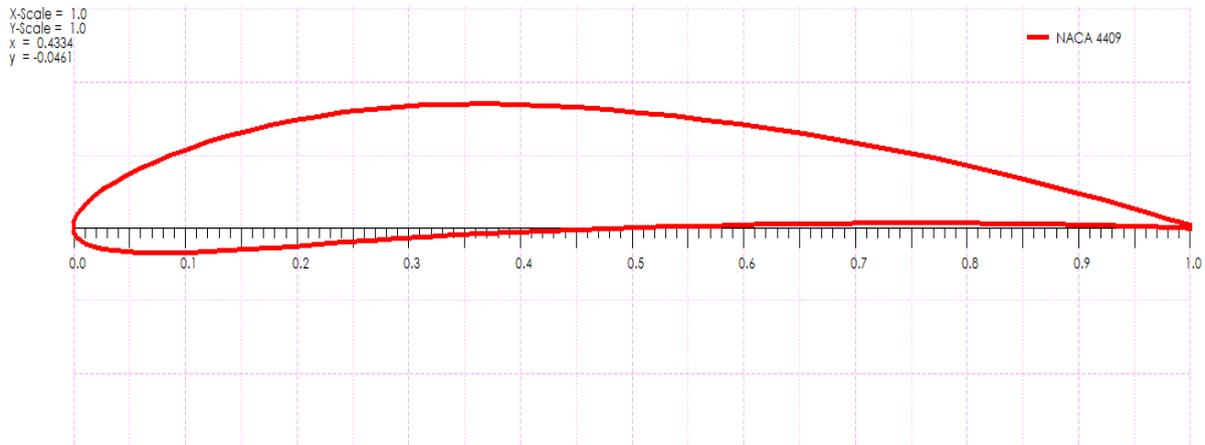
Figure III.1 : Profil NACA 4409.
