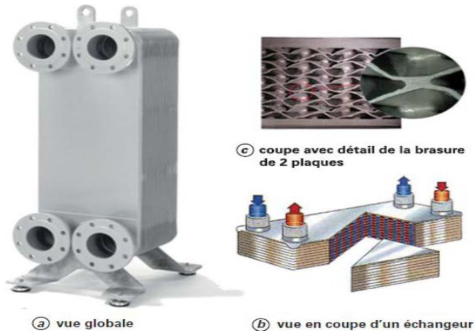
Figure II.25 : Échangeur à plaques brasé.
