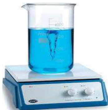
Fig. I.1. Champ de vitesse créé par un agitateur magnétique.
