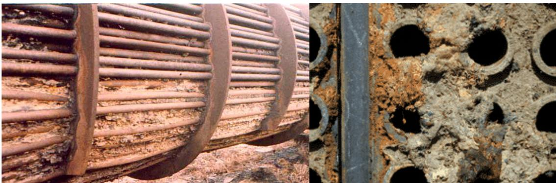
**Figure 2.22 :** Echangeur tubulaire encrassé
