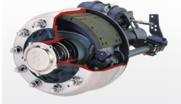
Fig.I.12. Montage d'un frein à tambour
