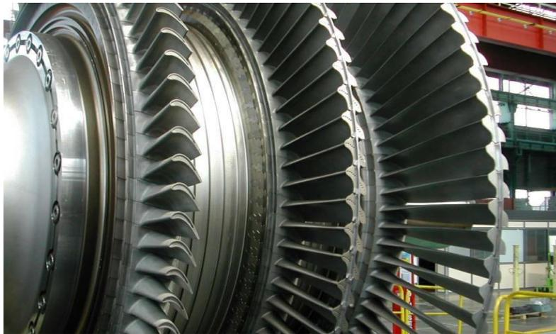
**Figure II.15: Rotor de la turbine**
