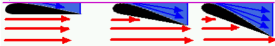
Figure II.5- Variation de la pression en fonction de la section de passage selon le théorème de Bernoulli [04]
