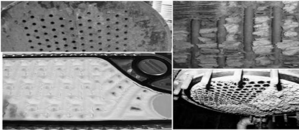
Figure II.34. Phénomènes d'encrassement dans les échangeurs.
