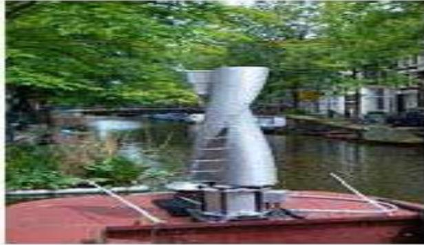
Figure 6 source éolienne de type Savonius (Windside) [1]
