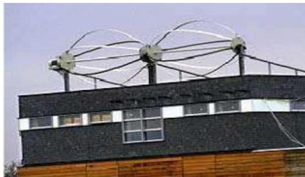
Figure 7 éolienne de type Darrieus (WinWall) [1]
