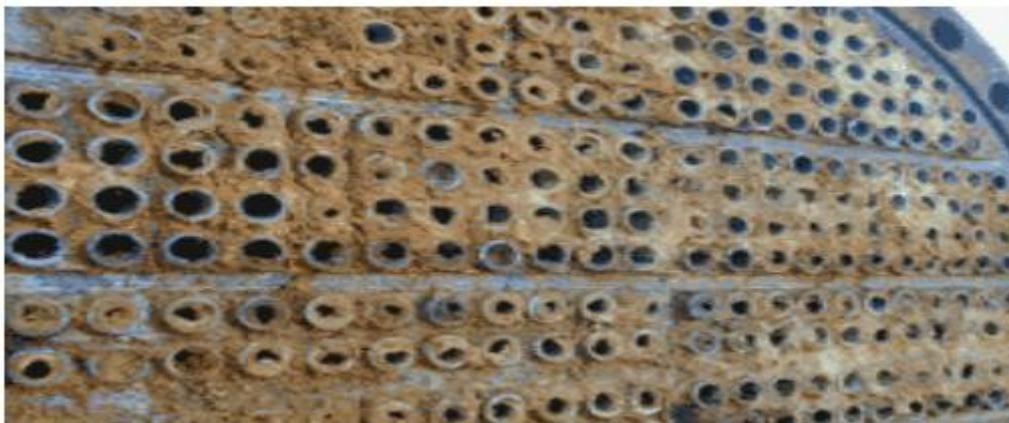
**Figure II.9 :** L'encrassement dans un échangeur tubulaire
