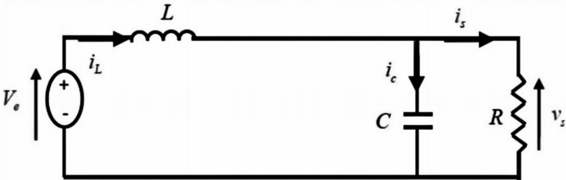
Figure III.5. Circuit équivalent du Boost quand l'interrupteur est ouvert [25].
