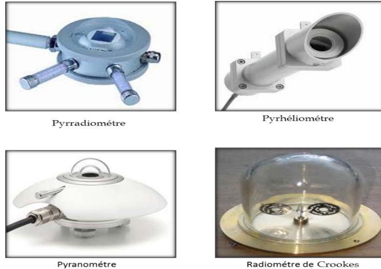
Figure II.11: Différents instruments de mesure du rayonnement solaire.
