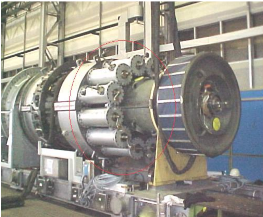
Figure (II.14) : Chambre de combustion de la turbine à gaz MS 5002C.
