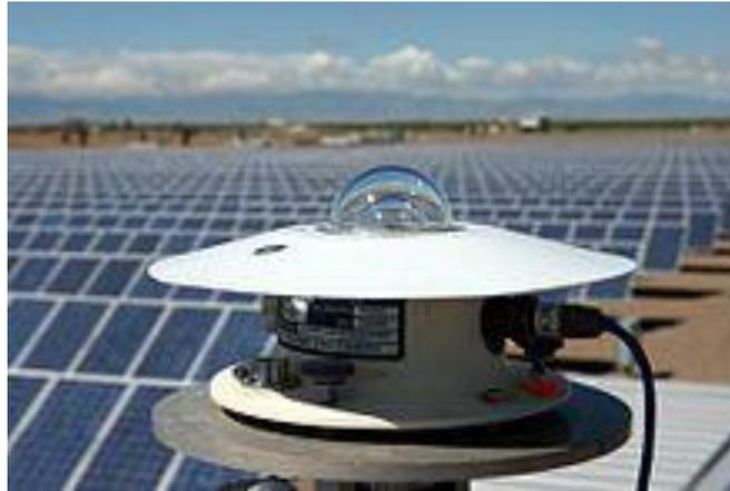
**Figure (I-12) :** Le pyranomètre.
