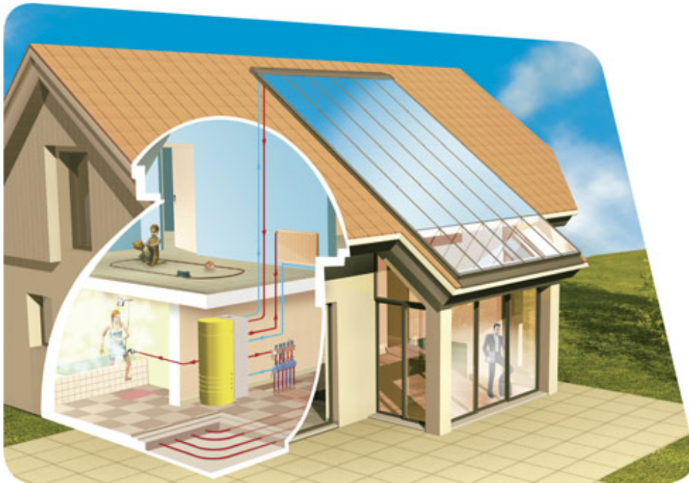
Fig. II-7- Plancher solaire direct .
