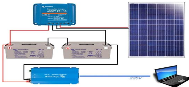
Fig. I-17. Systeme autonome avec batterie .
