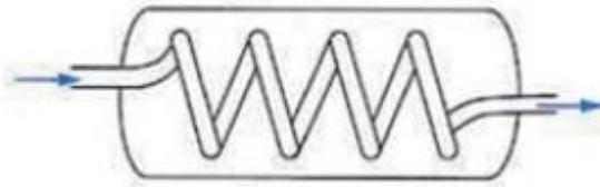
Figure II.1: Echangeur monotube en serpentín
