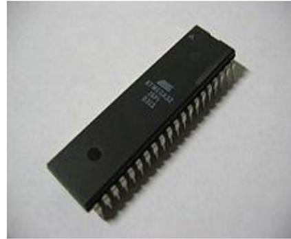
Figure II.4 Un microcontrôleur boîtier DIP.
