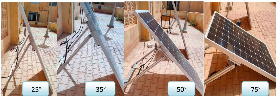
Figure III. 13: Inclinaisons du panneau solaire.
