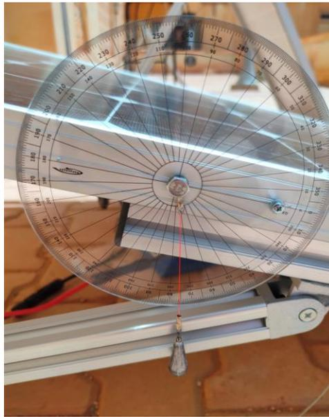
Figure III. 4: Rapporteur d'angle d'inclinaison.
