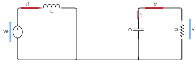
Figure III. 6 Circuit équivalent du Boost quand l'interrupteur est fermé.
