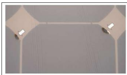
Figure II. 15: Modules présentant des points chauds sur les bords des coins supérieurs.
