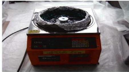
**Figure(IV.14) :** Dépôt de 60 nm de PEDOT : PSS par spin coating et image de l'appareil utilisé pour la mise en forme des films minces en solution.
