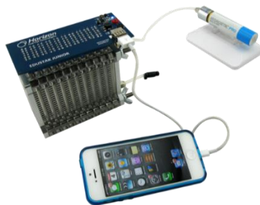
Figure IV-7 : Un système à pile à combustible utilisé pour un téléphone portable
