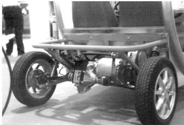
Figure V-6 : Transmission complète avec les deux moteur- roues
