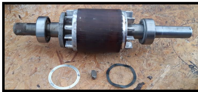
Figure I.5: rotor à cage d'écureuil
