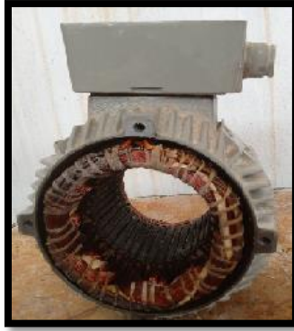
Figure I.4: stator d'un moteur asynchrone
