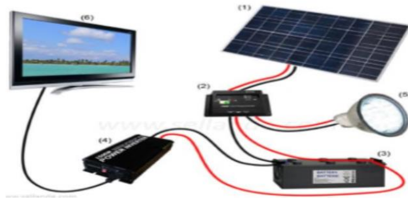
Figure (I.10): Système photovoltaïque autonome.
