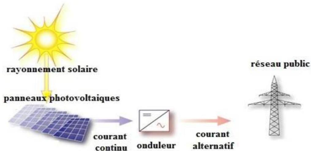
**Figure I.1:** schéma de principe d'un générateur photovoltaïque.
