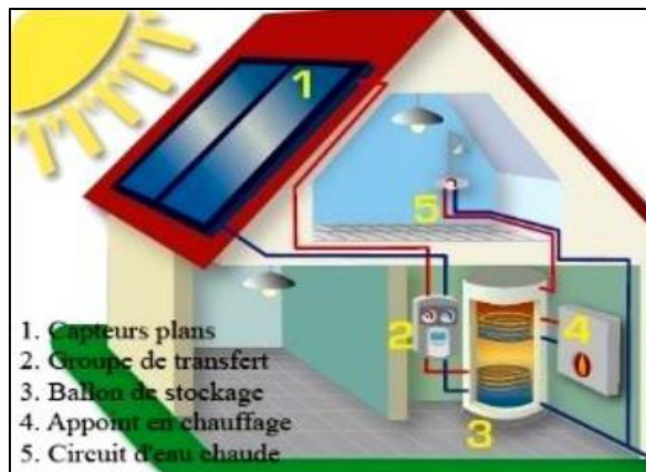
Figure I.17 : Energie solaire thermique. [31]
