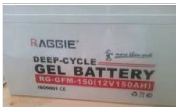
Figure III.8 : Batterie de 150 Ah/12V. [84]
