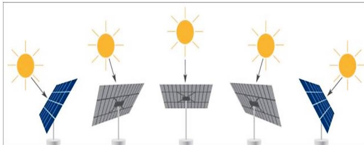
Figure 1.18 Structure de suivi du soleil
